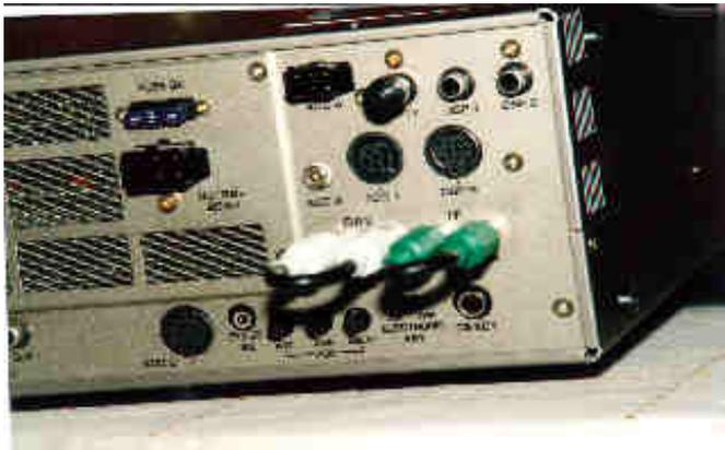
Diese muß man für den normalen KW-Betrieb nur außen mit Cinch-Cinch-Koaxkabeln brücken. Da es sich um Kurzwelle (d. h.  $f < 30\text{MHz}$ ) handelt, dürfte die auftretende Dämpfung vernachlässigbar sein.
